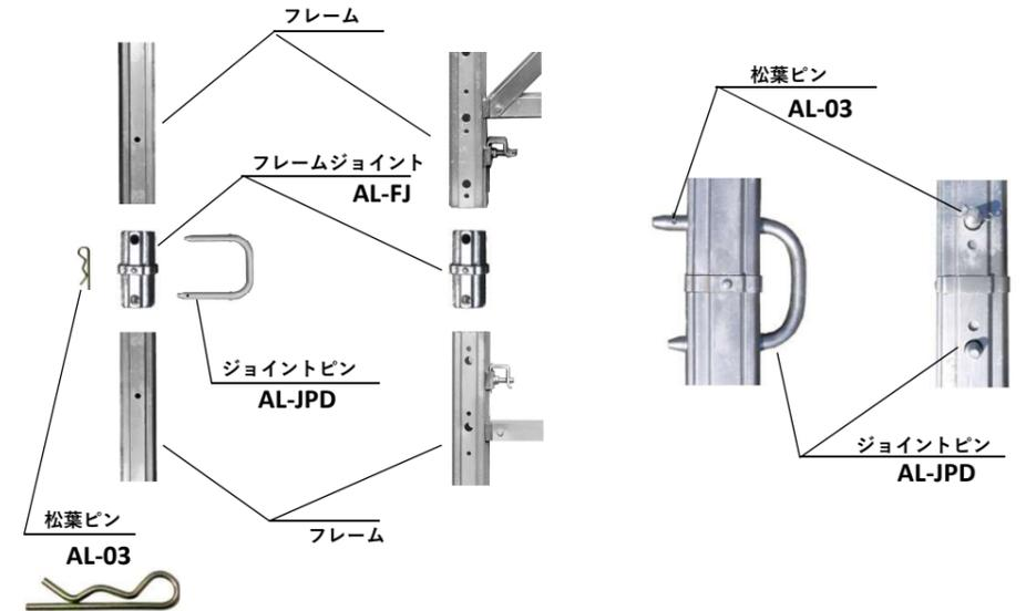
ジョイントピンには松葉ピンで抜け止めをして下さい
