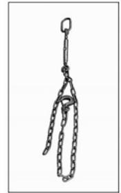
2) 架設するベスパを先端付近に移動し取付吊具を取付ける。
