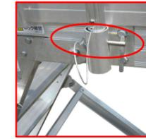
B 手すりの抜け止めピンを忘れずに。
