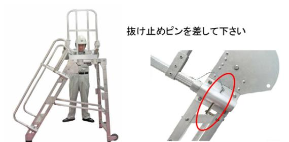
階段部を持ち上げることで、背面のキャスターが接地し簡単に移動できます。
