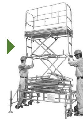
1段伸ばす毎にタラップ枠を起し伸縮ロックを掛け、次の段を伸ばしていく
