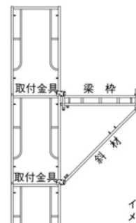
2) -3 上下の取付金具へ梁枿と斜材をボルトで固定する。
