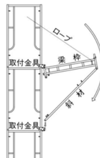
2) -2 上層にてロープを支持し、下層で斜材をガイドし、下の取付金具へ取付ける。
