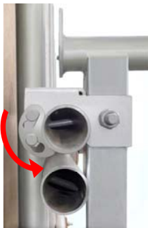
落下錠を確認して下さい
