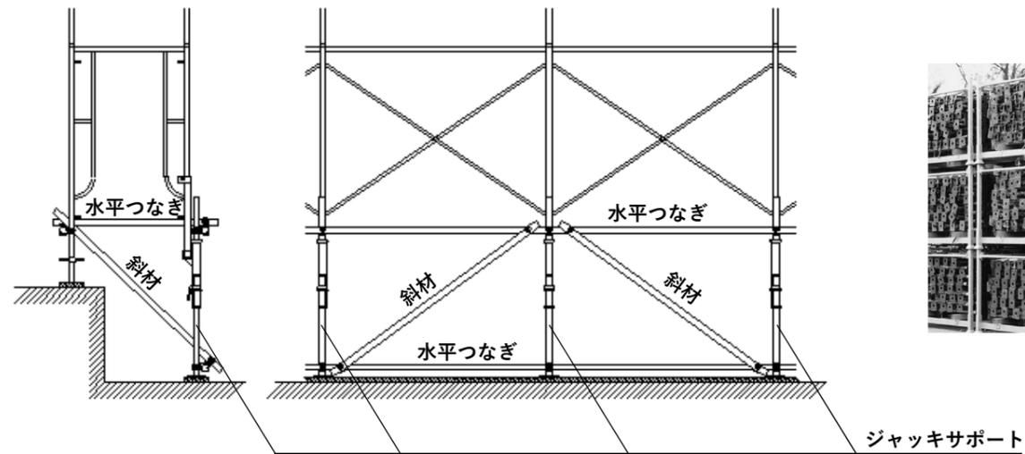
単管パイプとクランプで寝がらみ、水平つなぎ、斜材を設けて下さい。
