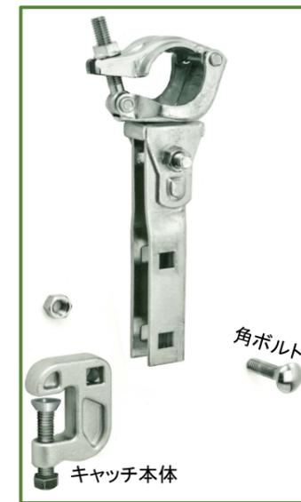
角ボルトは必ずキャッチ本体の角穴の部分から差し込んで下さい
